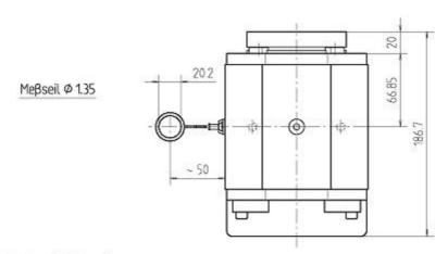
Anbaubar sind Geber mit: - Synchroflansch Ø50 / Tk Ø42 / 3xM4
